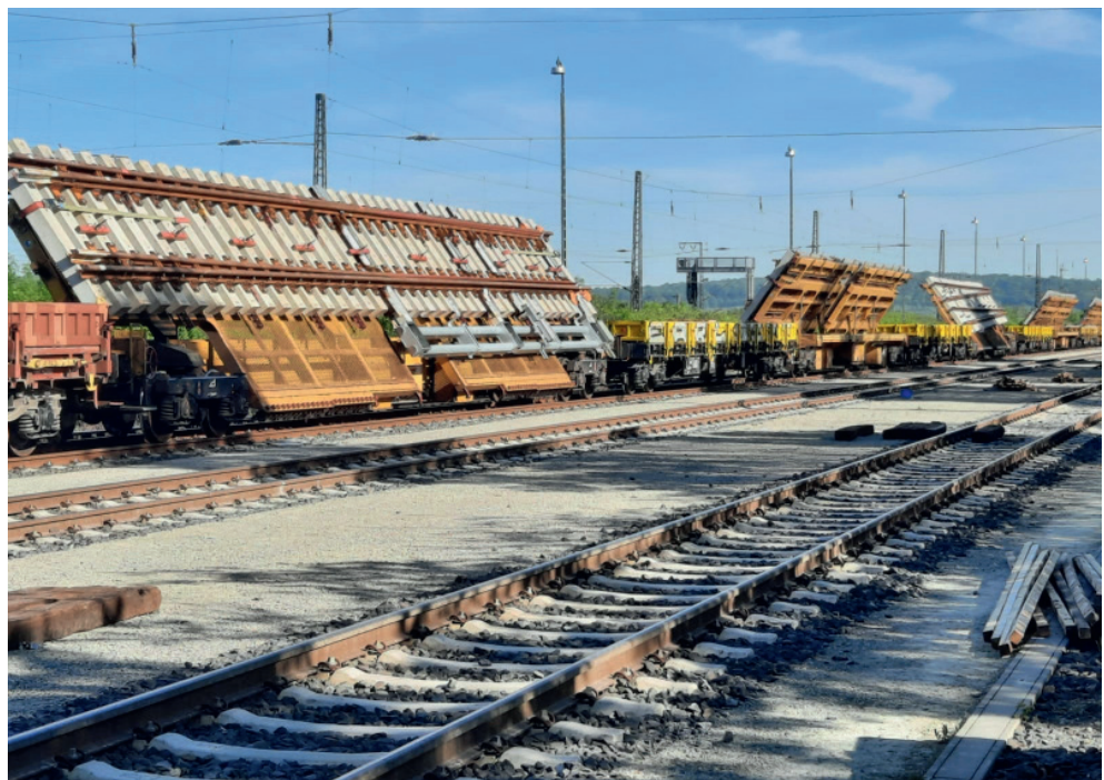
Bild 5: Weichentransportwagen (WTW) mit vormontierten Weichenbestandteilen
